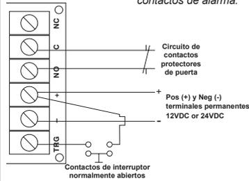
Para esta aplicación, el interruptor N° 1 debe estar en la posición de apagado y el interruptor N° 4 debe estar en la posición de encendido.
