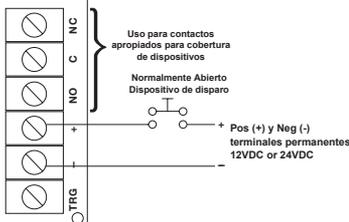
Para esta aplicación, el interruptor N° 1 debe estar en la posición OFF y el interruptor N° 4 no se utiliza en esta aplicación.
