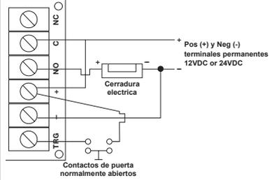
Para esta aplicación, el interruptor N° 1 debe estar en la posición de apagado y el interruptor N° 4 debe estar en la posición de encendido.
