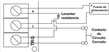
Para esta aplicación, se debe instalar una resistencia [para 12VDC - 2K (2,000 ohm) o para 24VDC - 4.7K (4,700 Ohm)] como se muestra (resistencia no suministrada).
