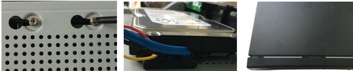
4. Gire el DVR para ver la parte posterior. Apunte los tornillos del HDD a los orificios en la parte posterior del DVR y luego apriete los tornillos.
