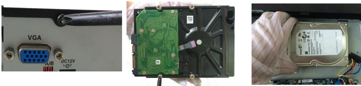
1. Quite los tornillos para tomar 2. Fije los tornillos en el HDD 3. Coloque el HDD en la tapa.
