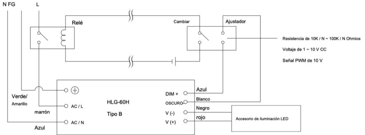
El uso de un interruptor y un relé puede ENCENDER / APAGAR la lámpara.
