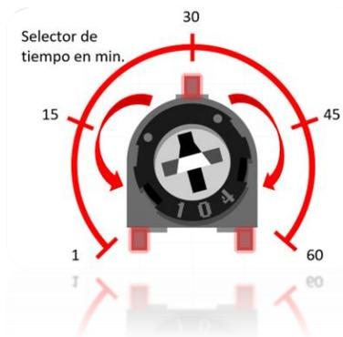
El sistema de alarma integra en los energizadores la función de un **Temporizador de sirena**, en
